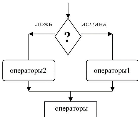
Рис. 2.2 Блок-схема фрагмента программы (слева), схема её реализации с использованием условного оператора if ... else и пример (справа).
